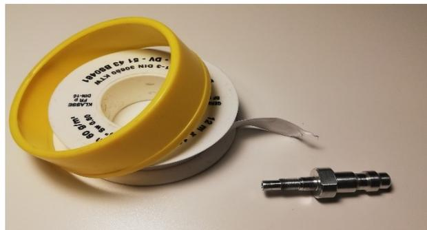
**Bringe Teflonband gegenläufig zum bzw. auf das Gewinde des HPA Adapterventil an**
