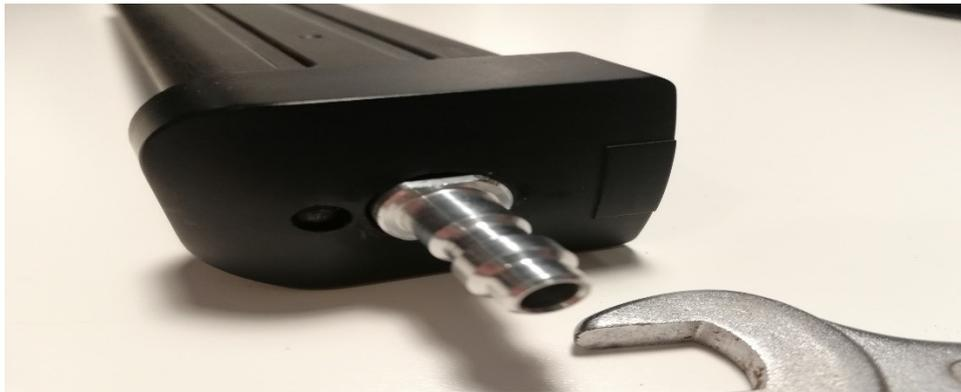
**Bringe die bearbeitete Abdeckplatte wieder an dein Magazin an und verschraube mit dem 10“ Maulschlüssel das HPA Adapterventil**
