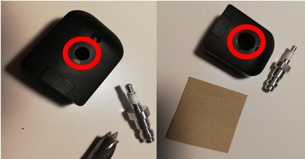
**3.1 Bohre mit dem 10“ Bohrer die Abdeckplatte an der Rot gekennzeichneten Stelle auf**
