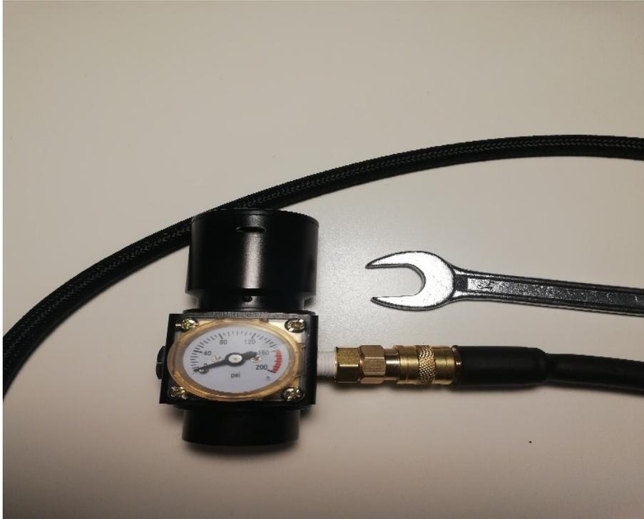
**Verbinde den Balystikslauch mit dem 14“ Maulschlüssel mit dem Regulator und anschließend den Regulator mit HP Tank**
